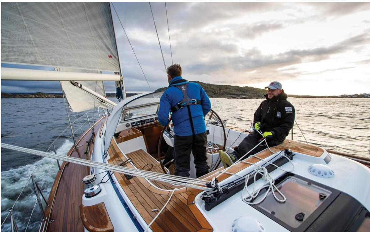
Ist bis hierher soweit gewährleistet, dass das Boot seetüchtig ist, folgt das Sea Trial. Hierbei wird mit dem Skipper ein detaillierter Ablaufplan unterschiedlicher Manöver festgelegt, damit sichergestellt wird, dass alle kritischen Systeme entsprechend belastet werden, um deren einwandfreie Funktion zu überprüfen.
