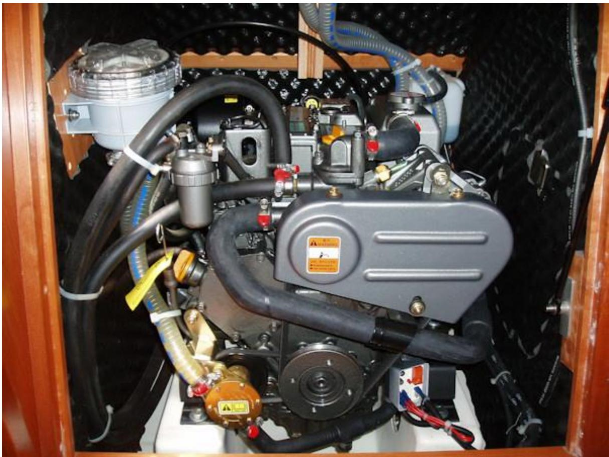
Im Anschluss geht es an das Herzstück jedes Bootes: der Maschinenanlage inklusive der zugehörigen Peripherie. Routinemäßig werden die Pegelstände für Öl im Motor und Getriebe, Kühlflüssigkeiten, Filter, Sichtprüfung der elektrischen Anschlüsse, Spannung Antriebsriemen, Zustand Impeller, etc. geprüft.
