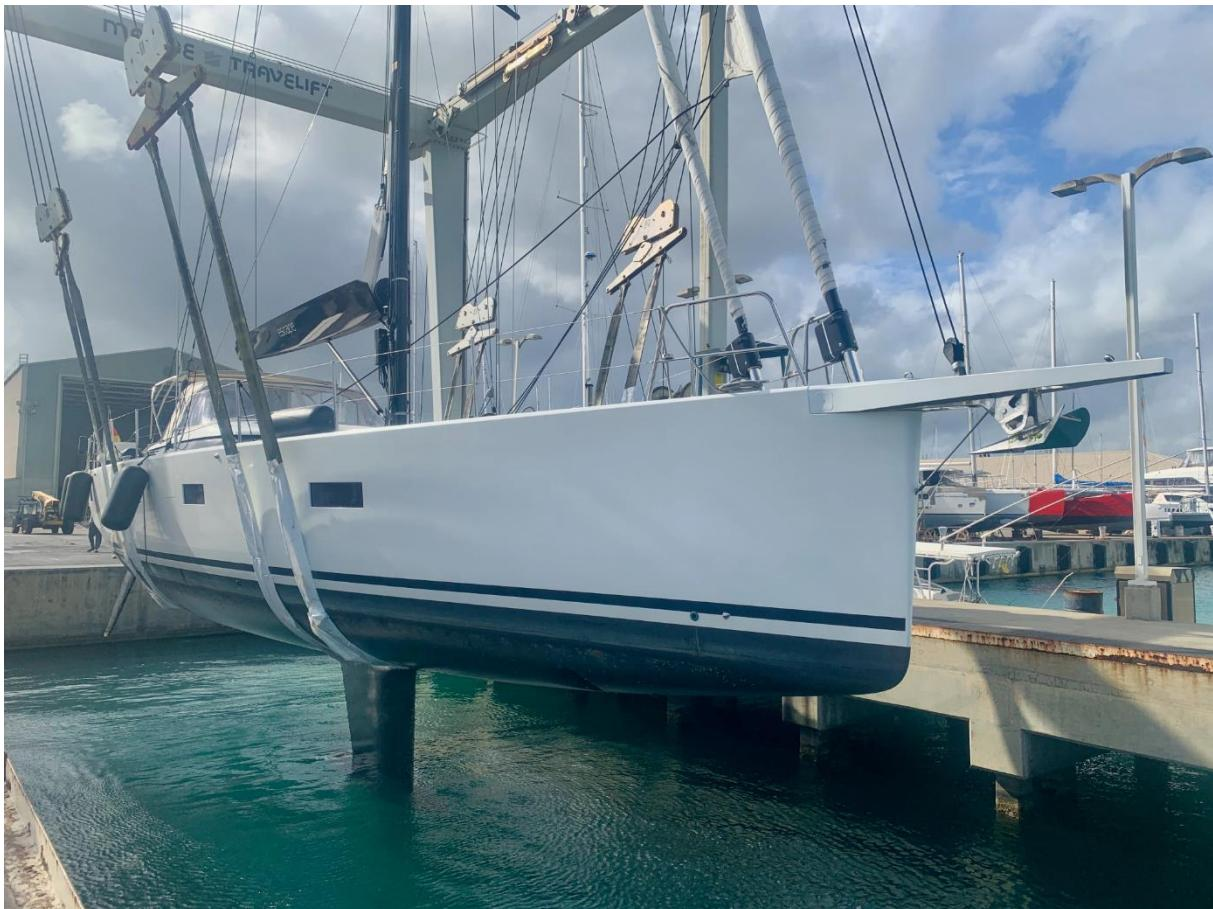
Die Inspektion des Rumpfes bildet in der Regel den Auftakt der Besichtigung und enthält neben der Überprüfung des Unterwasserschiffs auch die Prüfung aller Borddurchlässe/ Seeventile sowie der Steuer- und Antriebsanlage.
